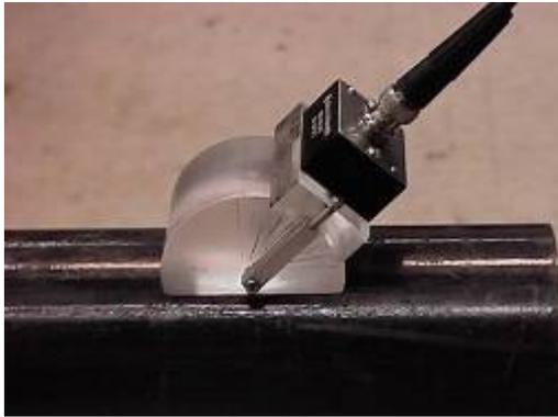
a). angle beam probe
